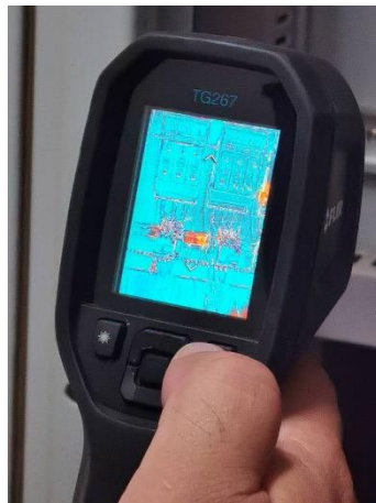
ตรวจวัดโดยกล้องตรวจจับความร้อนที่ main breaker ของคาปาซิเตอร์
