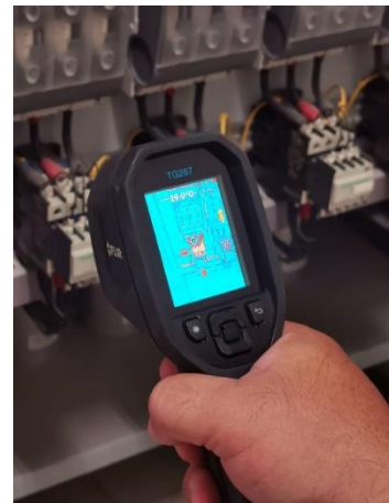
ตรวจวัดโดยกล้องตรวจจับความร้อนที่ main breaker ของคาปาซิเตอร์
